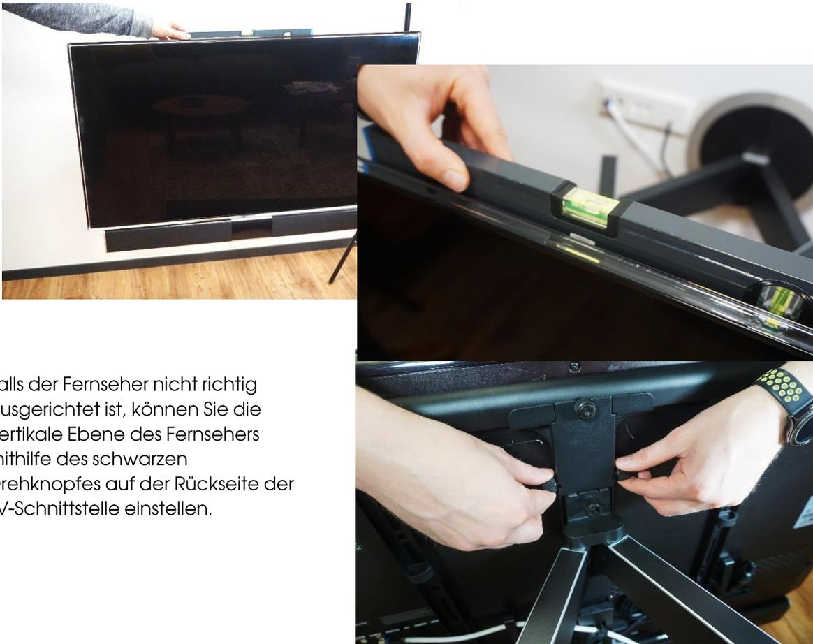
Falls der Fernseher nicht richtig ausgerichtet ist, können Sie die vertikale Ebene des Fernsehers mithilfe des schwarzen Drehknopfes auf der Rückseite der TV-Schnittstelle einstellen.
