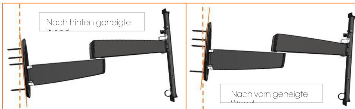
Wie Sie in der Abbildung rechts sehen, nivellieren Sie die Motion(Sound)Mount auf einer nach hinten geneigten Wand, indem Sie Unterlegscheiben hinter die oberste Schraube der Wandplatte legen.
